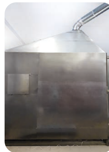
Огневой бокс для проверки качества пенообразователя
